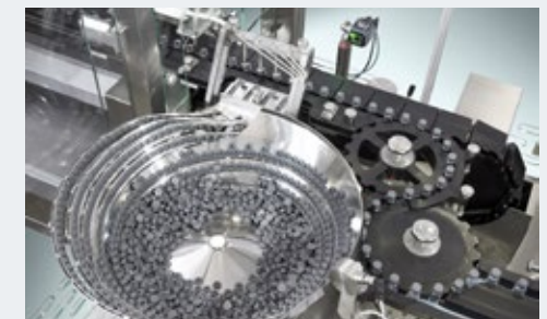
Direkt in den Fülltrichter der Abfülllinie unter dem Isolator.
